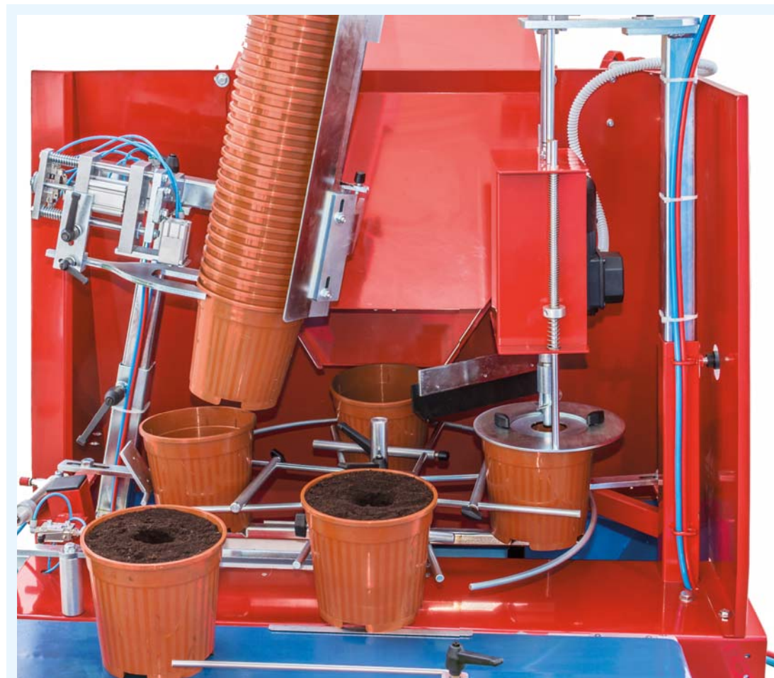
Versión de una cabeza : producción hasta 2400 macetas/hora .
