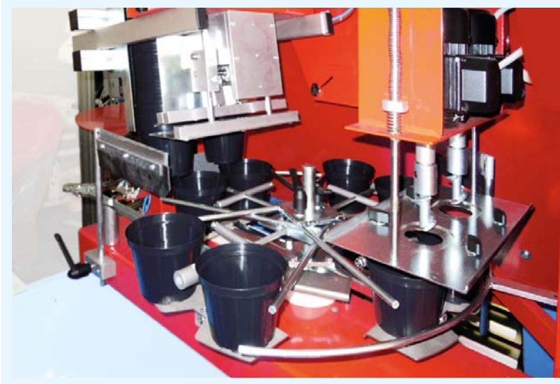
Versión de doble cabeza , para macetas de 8 a 14 cm: producción hasta 3500 macetas/hora .
