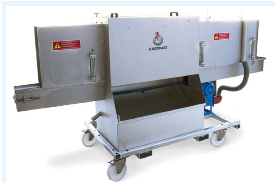
La provisión de un filtro de cajón abierto permite la limpieza incluso durante el ciclo de trabajo, sin interrupción .
