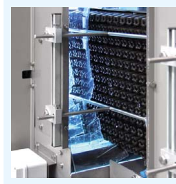
Túnel para el tratamiento de bandejas con lámparas de rayos UV.
