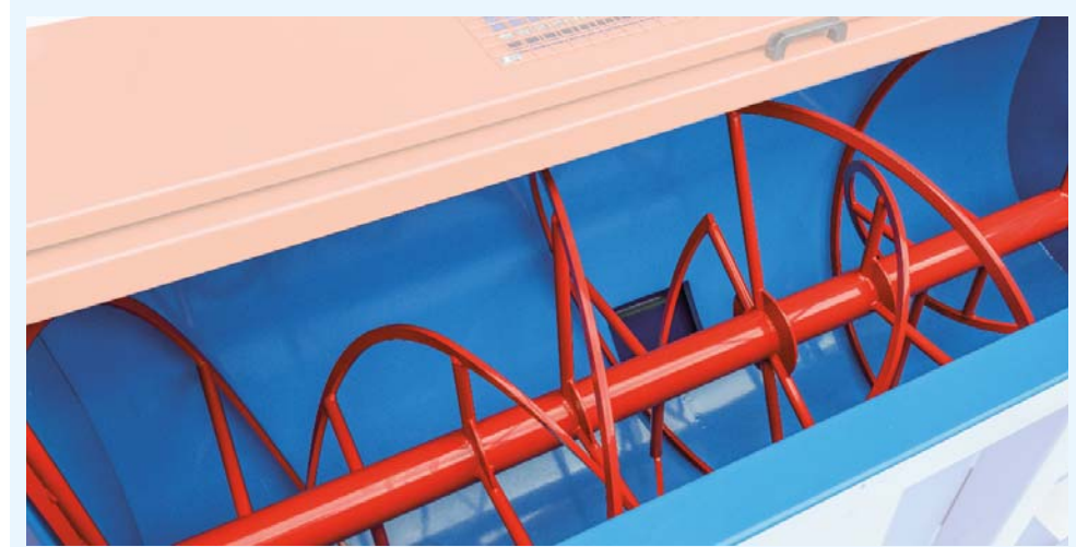
Rotor de doble espiral en acero de alta resistencia para reducir el desgaste.
