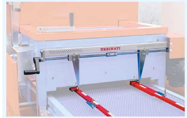
54 Sistema rápido de autocentrado y ajuste del ancho bandejas mediante manivelas.
