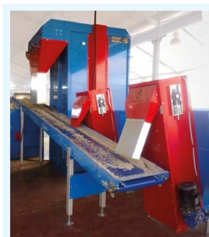
TR1800 en la función de dispensadora de vermiculita.
