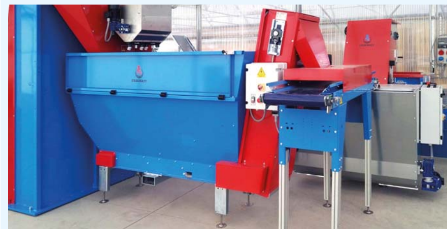
TR1800 en la función de “pulmón” para el sustrato, insertada entre CARBB y RN12, completa con cinta transportadora mod. NTV on patas especiales y lados laterales.
